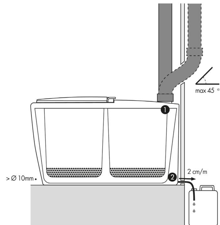
**1 Установка вентиляционной трубы**
